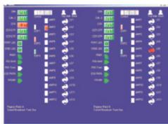
При обнаружении неисправности система, подключенная к ПК, регистрирует неисправность. В случае возникновения неисправности система также может автоматически направить уведомление по электронной почте пользователю или выбранной группе поддержки. Данная группа может включать отдел обслуживания интегрированных систем Federal Signal, который в состоянии обеспечить удаленную поддержку через Интернет.
